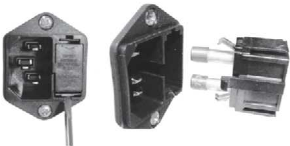
Fig. 3 Changement des fusibles
