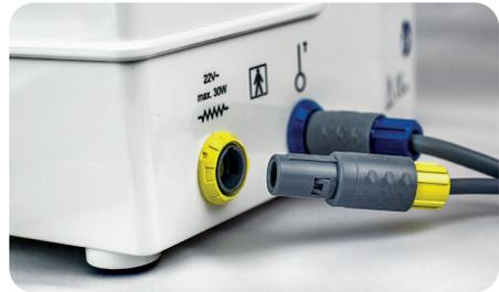
Netzstecker mit einer geeigneten Steckdose bzw. Steckdosenleiste mit zulässiger Spannung verbinden. Die Anschlüsse für das Heizdrahtverteilerkabel und den Temperatursensor sind seitlich am Gerät angebracht. Diese Anschlüsse sind farblich und mechanisch kodiert und mit entsprechenden Symbolen gekennzeichnet.
