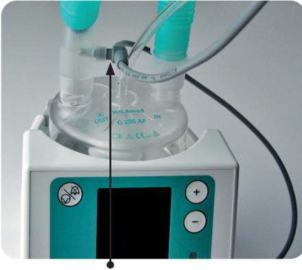
T-Sensor in Öffnung des Winkelsteckers
