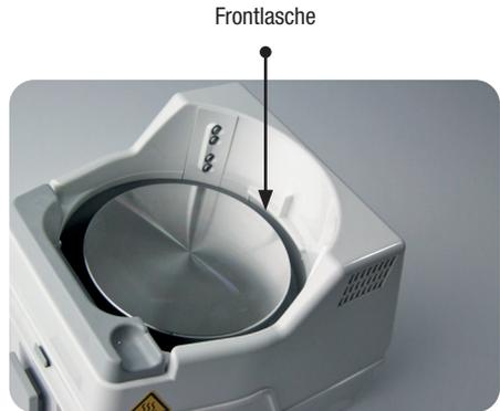
und danach unter den beweglichen Befestigungsbügel, welcher zurückgezogen werden kann, festklemmen, bis der Bügel hörbar einrastet.
